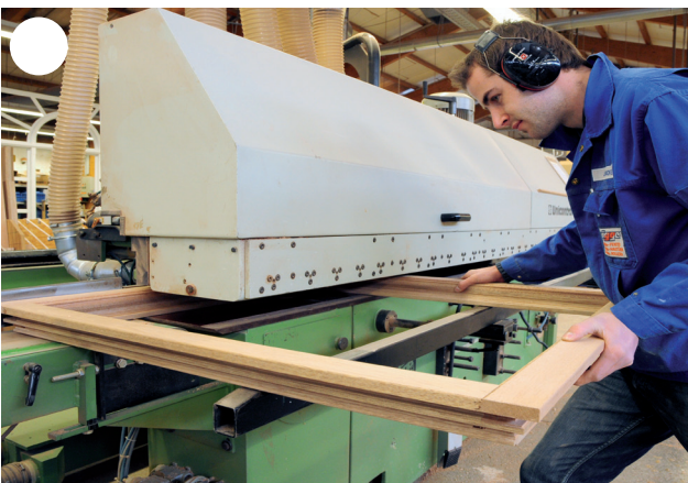
Am Umfälzautomat werden Unebenheiten im Profil des Fensterflügels geglättet.
