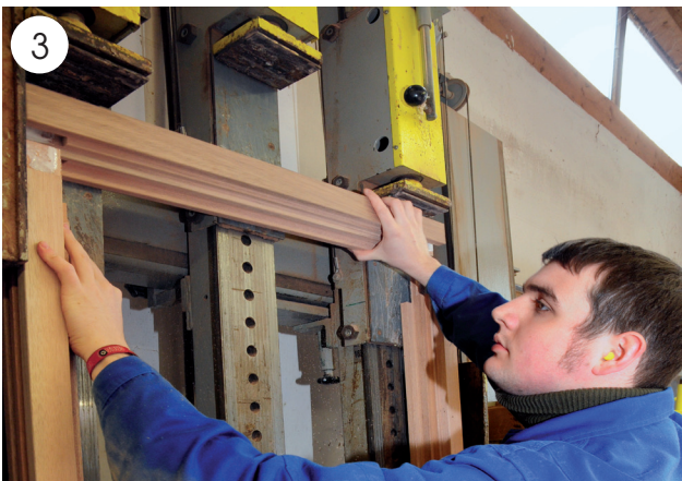
3 Die mit Leim bestrichenen Einzelteile des Fensterflügels werden an der Presse unter großem Druck zusammengefügt.
