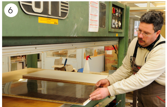
6 Die Furniere werden an der Presse unter Druck auf die Fronten geklebt.
