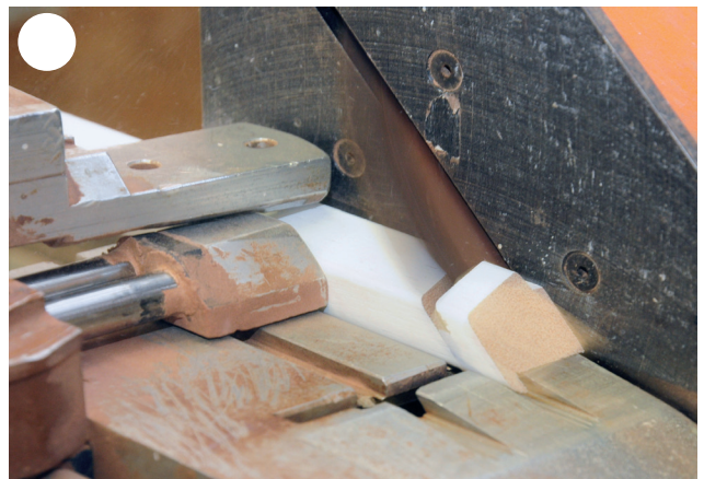
Die Glashalteleisten werden auf Gehrung zugeschnitten, damit sie in das Profil des Fensterflügels eingesetzt werden können.
