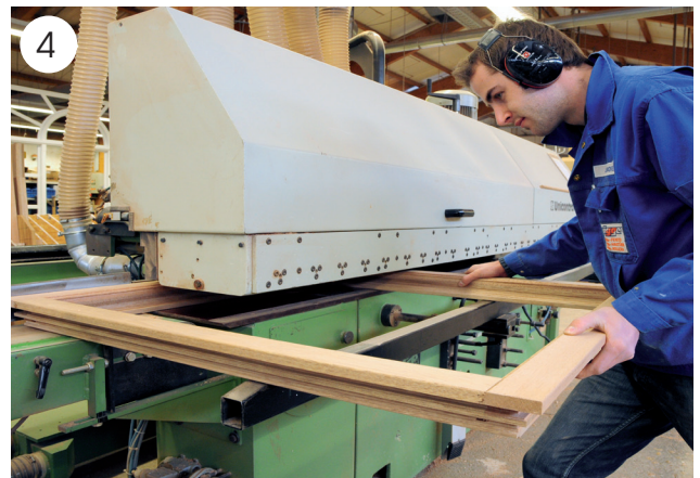
4 Am Umfälzautomat werden Unebenheiten im Profil des Fensterflügels geglättet.
