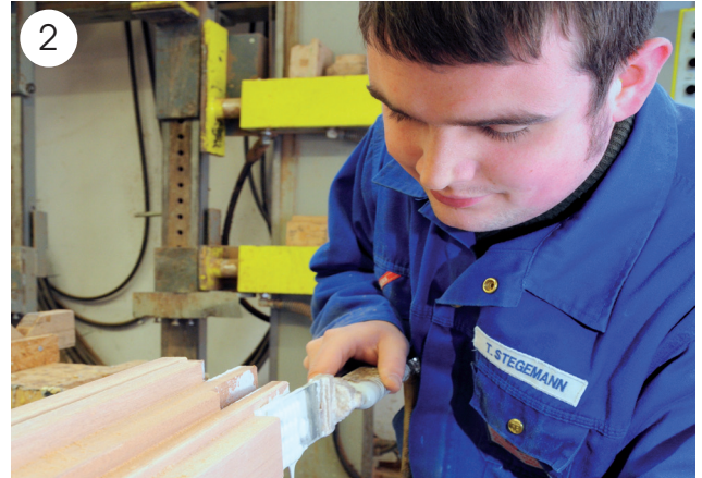
2 Der Geselle trägt Leim auf, der die einzelnen Teile des Fensterflügels später zusammenhält.
