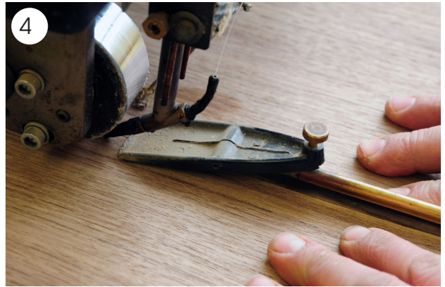
4 Zwei Furnierblätter werden mit einem Leimfaden zusammen gefügt.
