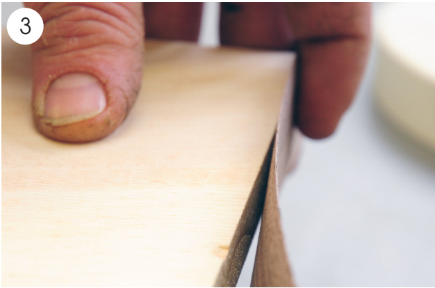
3 Der Schreiner prüft, ob die Kante zum Seitenteil passt, bevor er die Kante maschinell anleimt.
