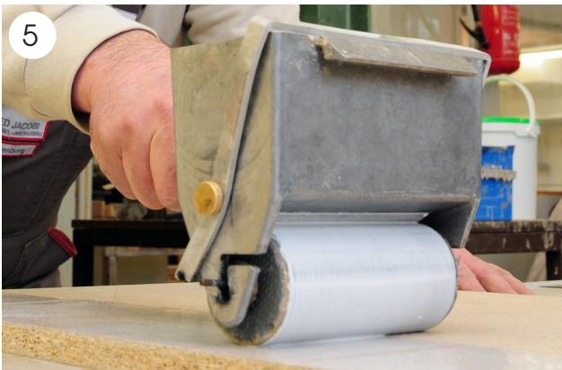
5 Von Hand wird der Klebstoff aufgetragen, mit dem die Furniere auf die Fronten geklebt werden.
